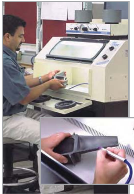
微喷砂技术可用来清洁涡轮叶片上的激光钻孔
