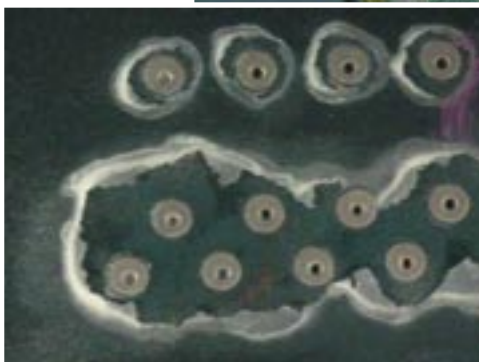
Vernis Acrylic sablé avec du bicarbonate de soude.
