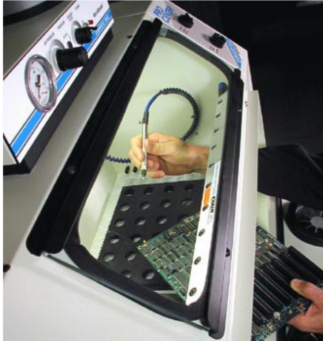
Un stylo support de buse est relié à un fil de masse, avec une buse conductrice.
