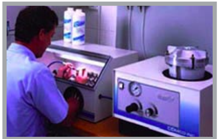
Sablage dans une station de travail classique avec un DirectFlo DF1400
