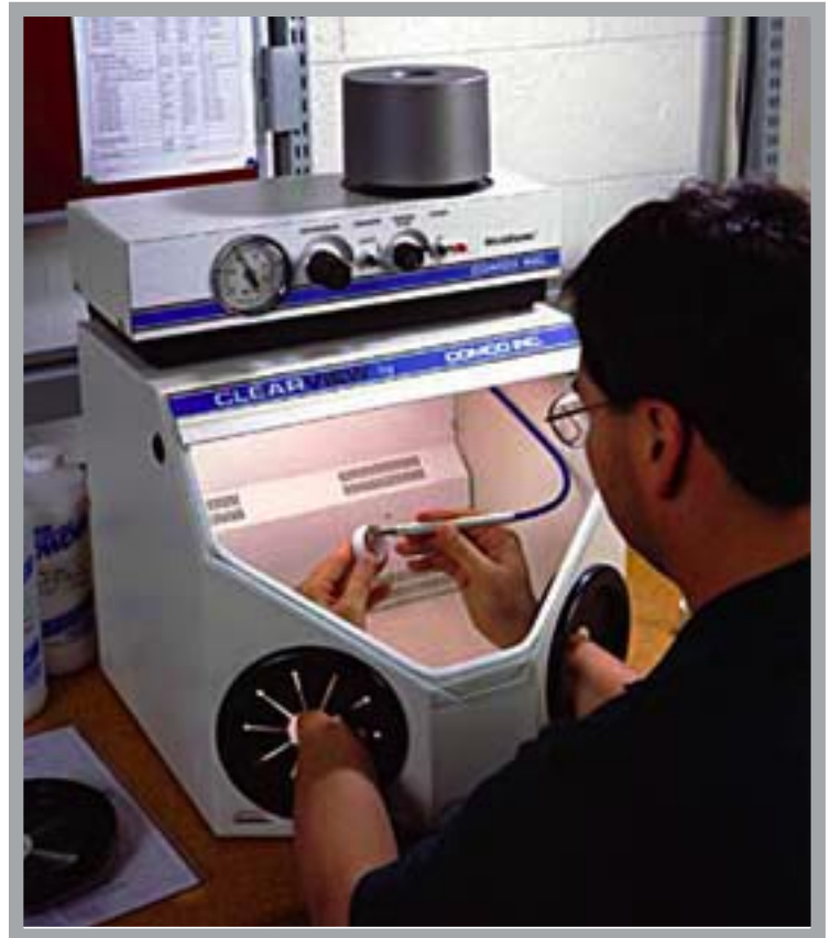
Microsableuse simple réservoir avec une chambre de travail « ClearView »
