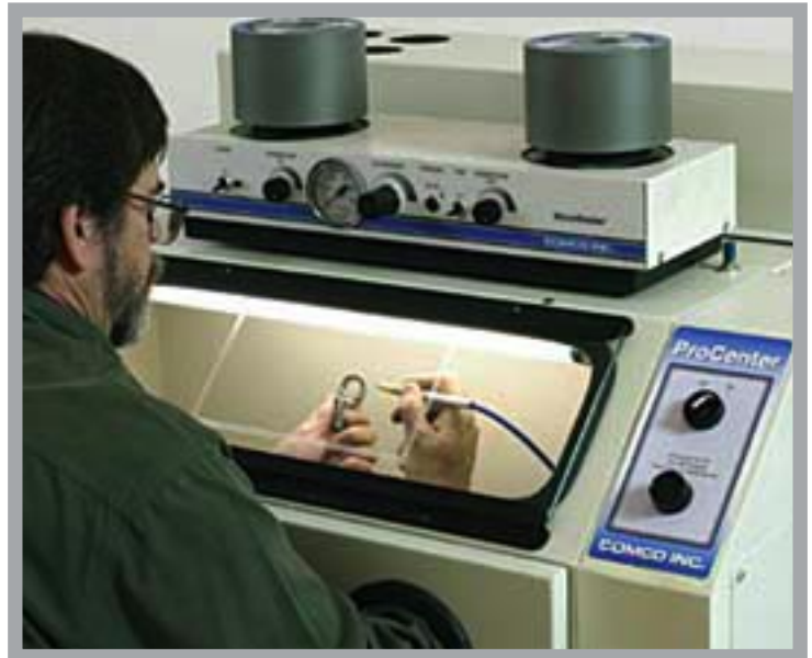
Microsableuse double réservoir avec le « ProCenter »
