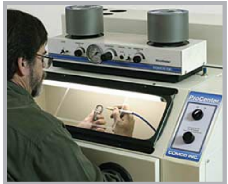
MicroBlaster® mit Doppelbehälter auf ProCenter
