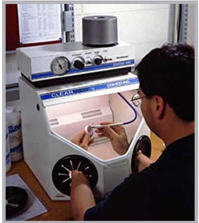
MicroBlaster® mit Einzelbehälter auf ClearView-Arbeitsstation
